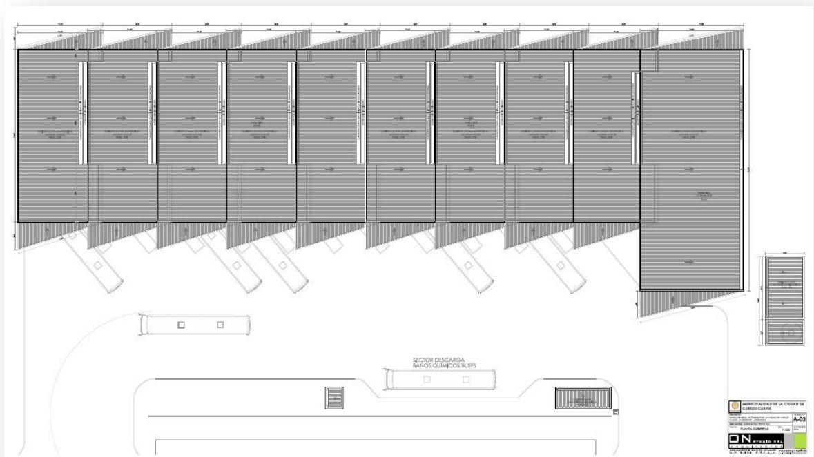
Figura 8. Planta de Cubiertas
